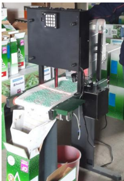
Obrázek 1: Fytolaser v procese ošetřování semen cukrové řepy.
